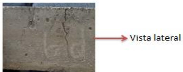
Figura 16. Fotografía grieta lateral muestra patrón.
