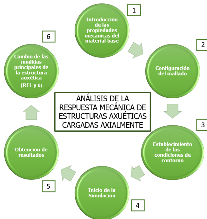
Figura 6. Metodología para la obtención de resultados, simulación de cargas axiales en estructuras auxéticas
