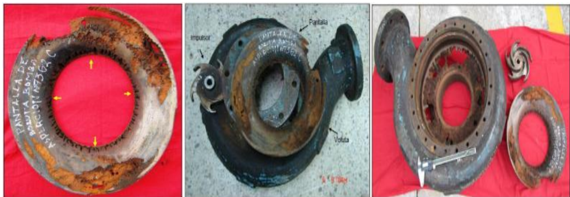
Figura 28. Corrosión en bombas centrífugas de las piscinas de aspersion.
