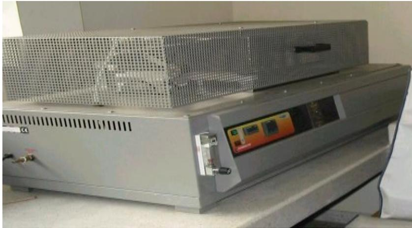
**2.3.1.1 Calibración del horno.** La calibración del horno se llevo a cabo ubicando una termocupla internamente a lo largo del horno a temperaturas que variaron entre 500° C-700° C determinando así la zona de trabajo. <sup>(2)</sup> Ver anexo C.
