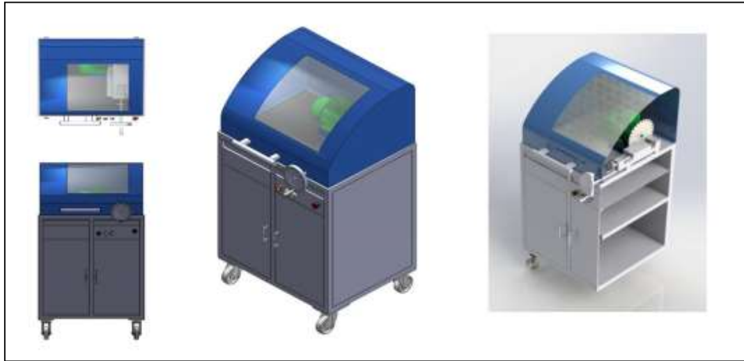
Figura 6. Perfiladora de núcleos con transmisión de potencia directa
