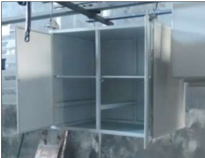
Figura 38. Inspección visual y envío a pintura del bastidor
