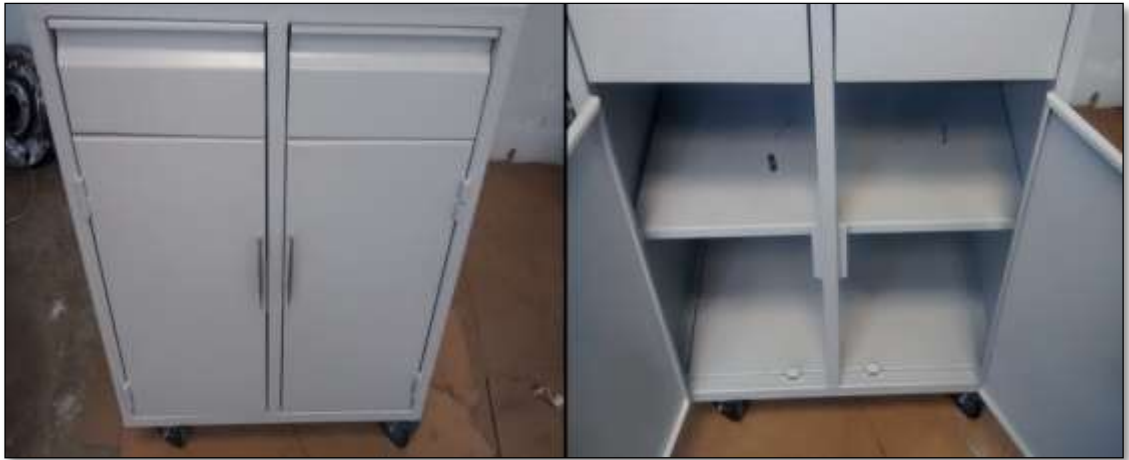
Figura 39. Instalación de puertas y ruedas al bastidor
