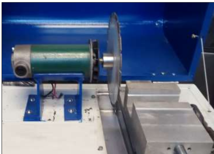
Figura 49. Instalación de la base para el motor
