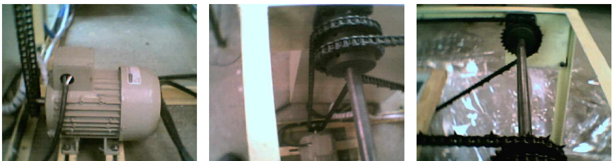
FIGURA 61. Motor y transmisión de cadena
