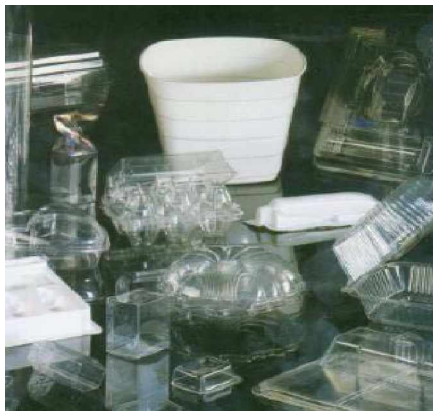
Figura 7. Empaques y productos conformados por termoformado
