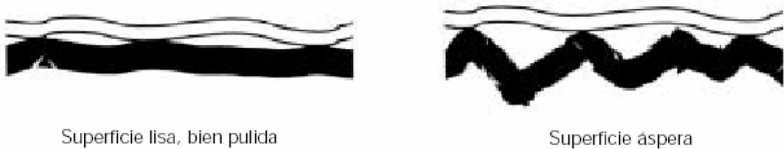
Figura 35. Superficies de molde en el termoformado
