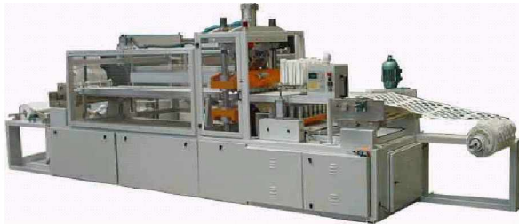
Figura 40. Ejemplo de termoformadoras alimentadas por rodillo
