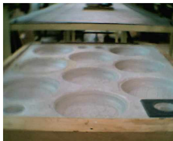
Figura 68. Molde hembra para la fabricación de platos y vasos
