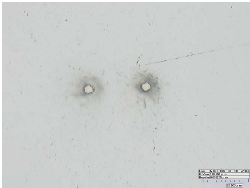
Figura 40. Precipitados presentes en el acero inoxidable Custom 455 corte transversal en estado de entrega, a 2800 x sin ataque.
