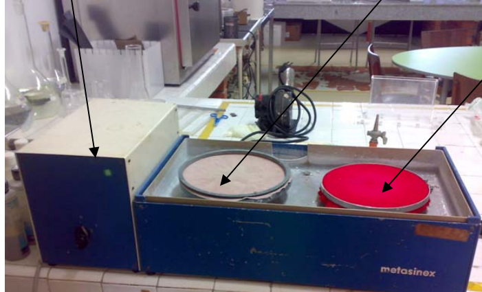
Figura 14. Pulidora marca metasindex, Paños Microcloth buehler y Redcloth buehler
