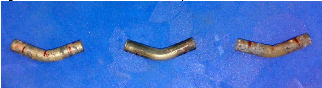
Figura 32. Probetas tratadas térmicamente ensayadas a flexión
