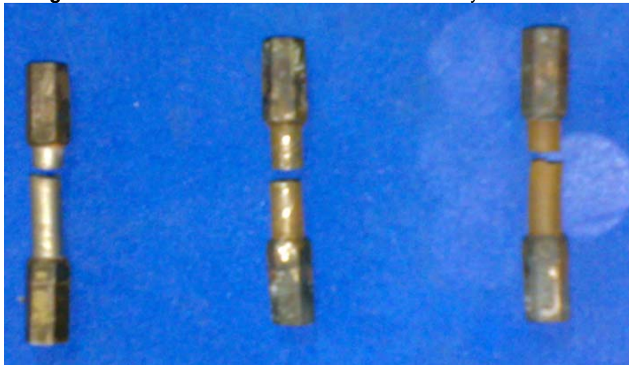
Figura 33. Probetas tratadas térmicamente ensayadas a torsión
