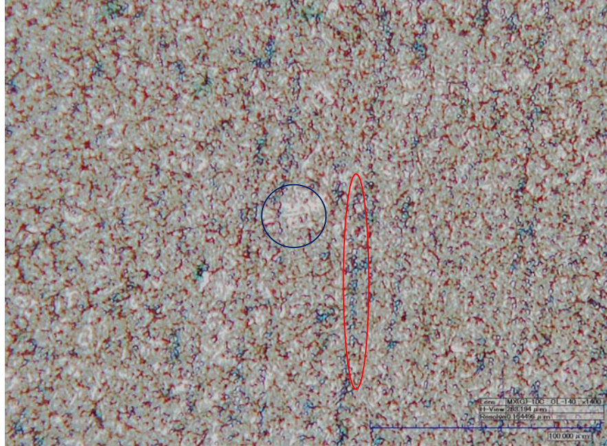
Figura 54. Microestructura del acero Tipo 420 templado a 1000°C y revenido durante dos horas y media 570°C, a 1400x corte transversal atacado con reactivo villeda's. círculo rojo carburos, círculo amarillo martensita fina y círculo azul martensita gruesa. Dureza 38HRC
