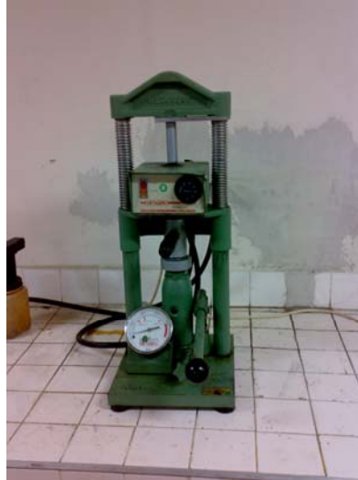
Figura 12. Maquina metaserv para el montaje de las probetas en bakelita.
