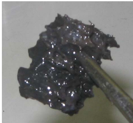
Figura 11. Biopelícula Anaerobia sobre el soporte orgánico seleccionado (tusa de mazorca).
