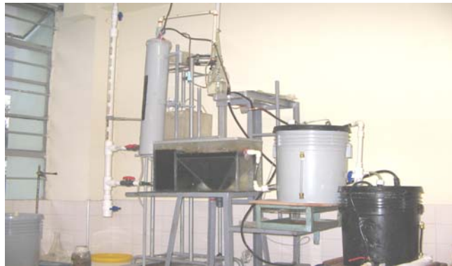
Figura 5. Sistema de biopelícula anaerobia soportada para el tratamiento de aguas residuales.
