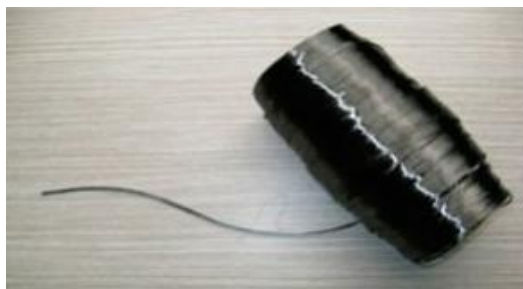
Figura 19. Carrete de fibras de carbono en hilo de aproximadamente 5 – 10 micrómetros de diámetro (SCOTT Sports SA. , 2017).
