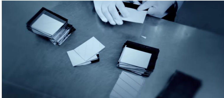
Figura 23. Preparaci3n de las capas cortadas de material de fibra de carbono (SCOTT Sports SA. , 2017).
