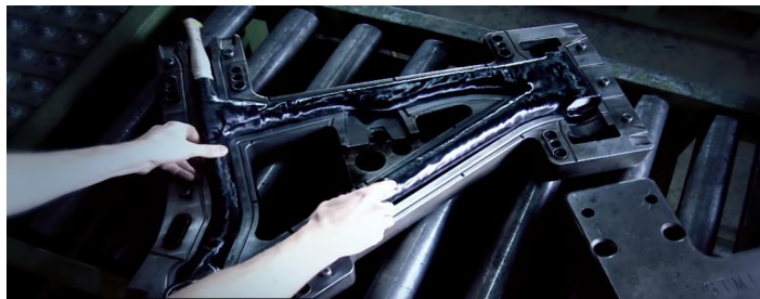
Figura 25. Marco prefabricado y moldeado (SCOTT Sports SA. , 2017).
