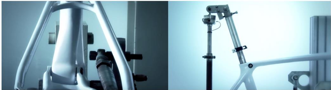
Figura 28. Pruebas de resistencia a la fatiga y rigidez de los marcos (SCOTT Sports SA. , 2017).
