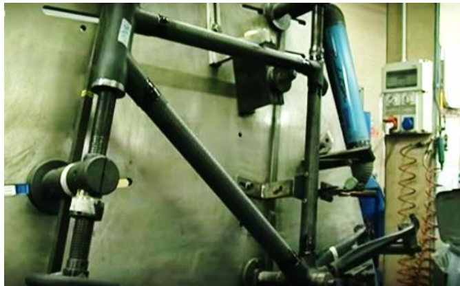
Figura 36. Montaje de prensa necesario para la manufactura del marco.
