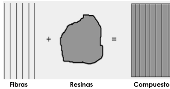
Figura 6. Estructura típica de los materiales CRFP (Carbonconcrete, 2008).
