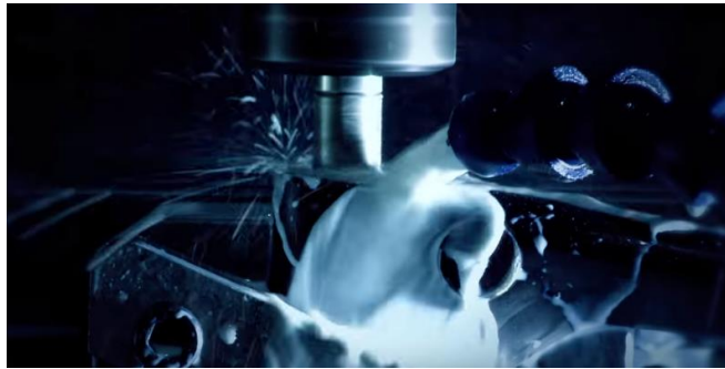
Figura 26. Mecanizado de las piezas para realizar el montaje final del marco (SCOTT Sports SA. , 2017).
