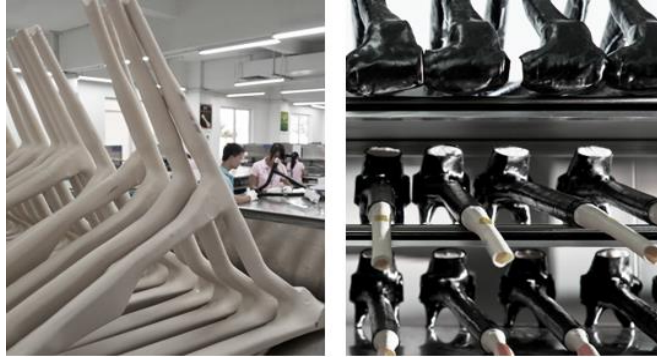
Figura 24. Preformado del marco de CRFP (SCOTT Sports SA. , 2017).
