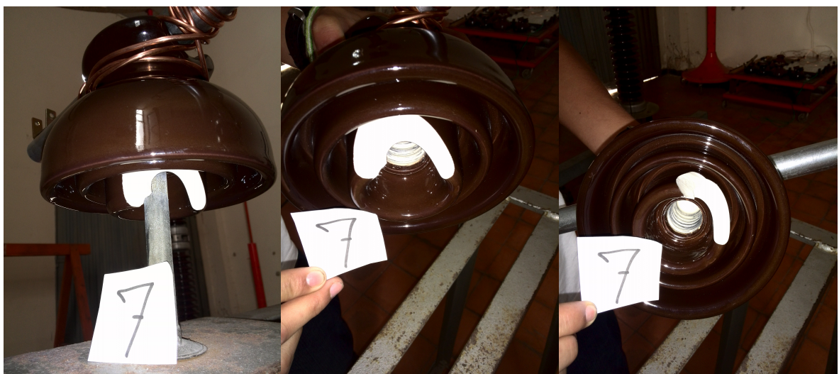
Figura 27: Objeto de prueba 7: daño mayor.
