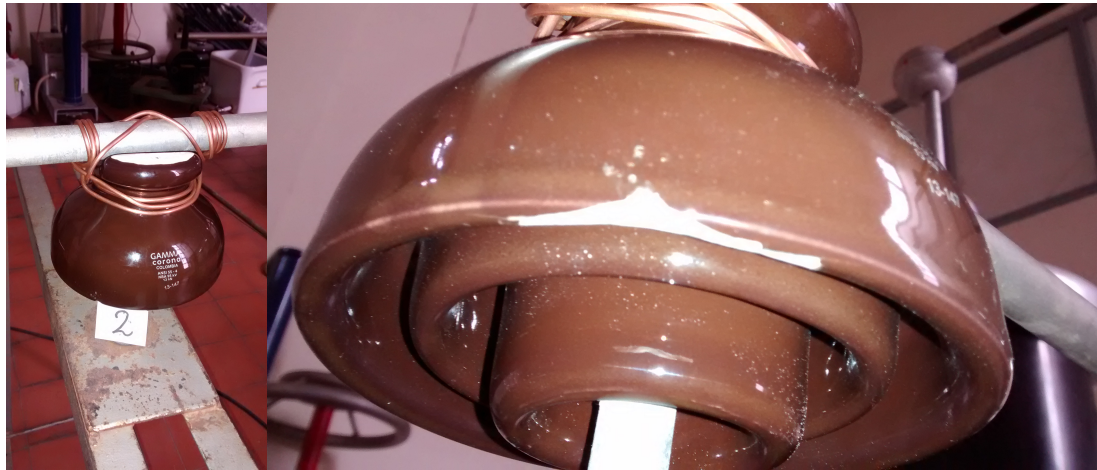
Figura 22: Objeto de prueba 2: daño mayor.
