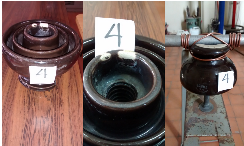
Figura 24: Objeto de prueba 4: aislador usado en campo - Daño crítico.
