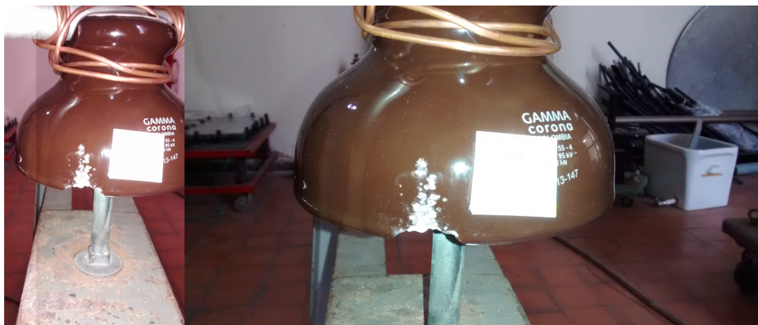
Figura 23: Objeto de prueba 3: daño mayor.
