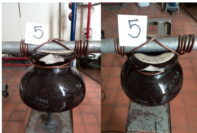
Figura 25: Objeto de prueba 5: aislador usado en campo - Daño crítico.
