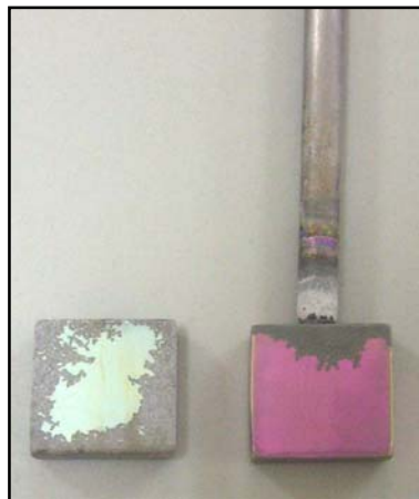
Figura 29. Piezas ensayadas a 30V y 55V con NaOH 1M a 24°C.
