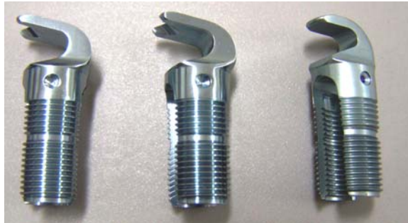
Figura 34 Ganchos torácicos y gancho pedicular ensayados en H_2SO_4 , H_2SO_4 + CH_3COOH y NaOH.
