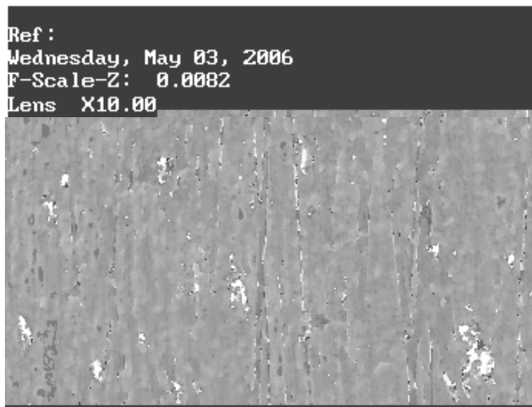
Figura 25a Superficie de una pieza pulida con lija 600 y anodizada.
