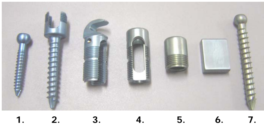
Fig. 38 Implantes ortopédicos de diferentes formas y tamaños en NaOH a 40V hasta 45 seg.
