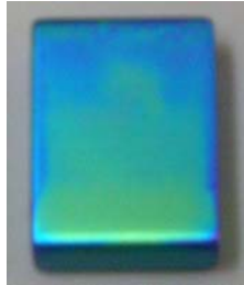
Figura 30 Pieza ensayada a 82V en NaOH 1M a 24°C.
