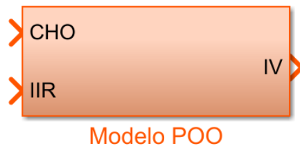
Figura 43. Subsistema de Simulink que contiene el Matlab System en el que se instancia el objeto del modelo del paciente diabético.
