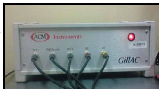
Potenciostato adquirido para la realización del estudio electroquímico de polarización potenciodinámica y OCP.
