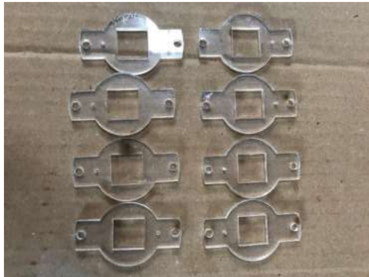
Figura 23 Soportes para las bobinas de campo
