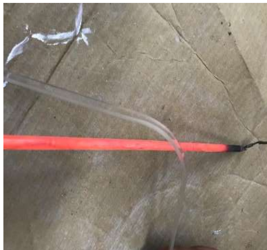
Figura 20 Proceso de termoformado en las piezas de acrílico
