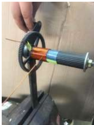
Figura 24 Proceso de construcción del solenoide
