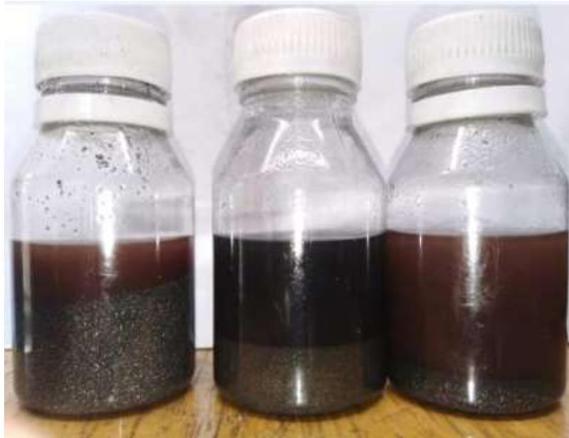
Figura 33 Muestras del fluido magnetorreológico
