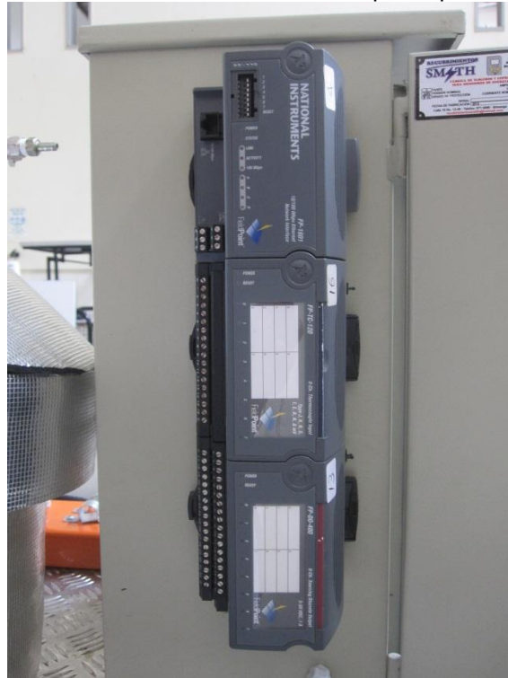
Figura 38. Disposición de los módulos del Field Point en el prototipo.
