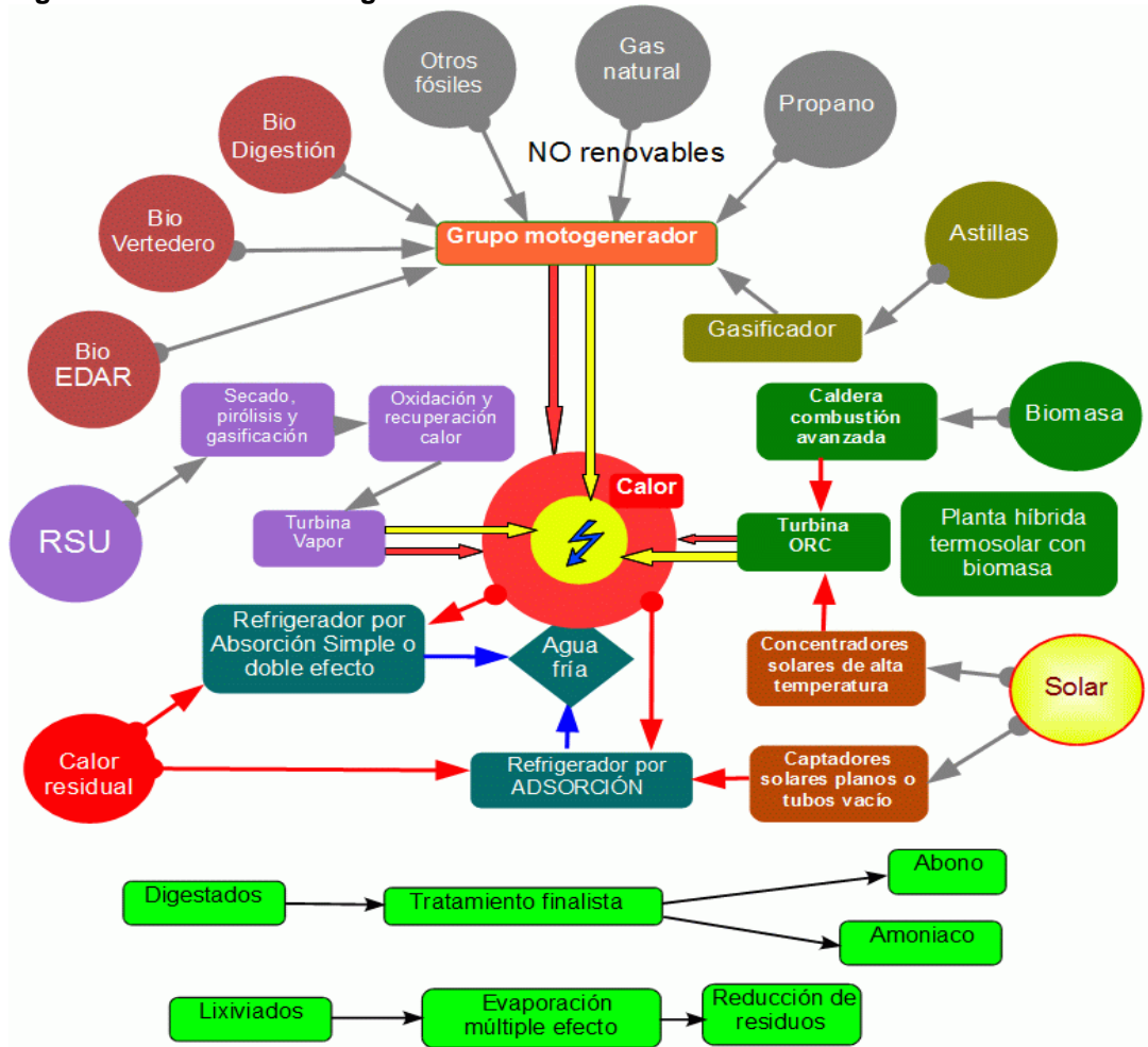
Figura 1. Fuentes de energía térmica.
