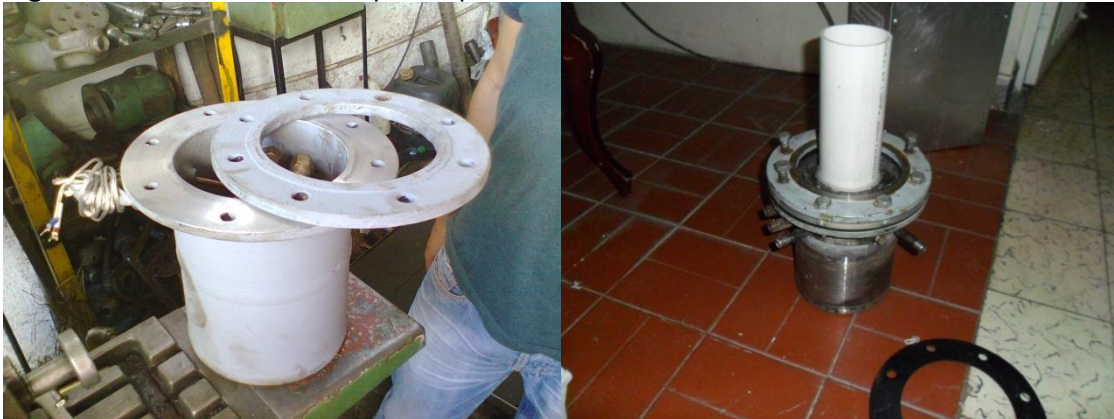
Figura 30. Modificaciones tanque evaporador-condensador.
