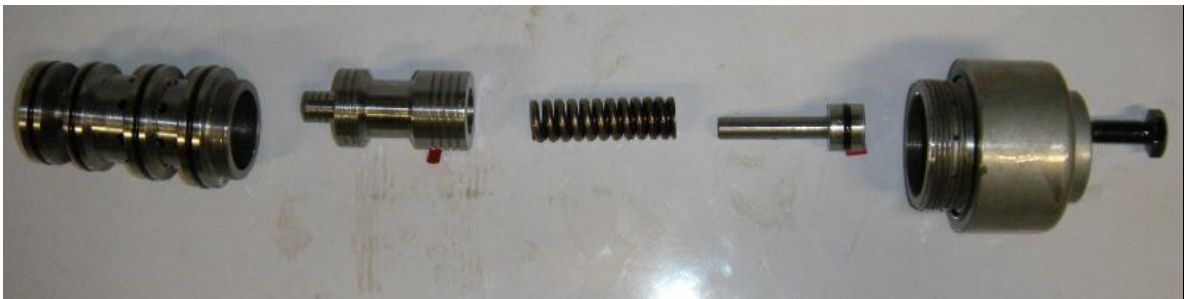
Figura 92. Explosión cartucho contrabalance especial.
