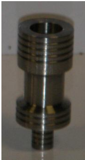
Figura 94. Pistón cartucho contrabalance especial.
