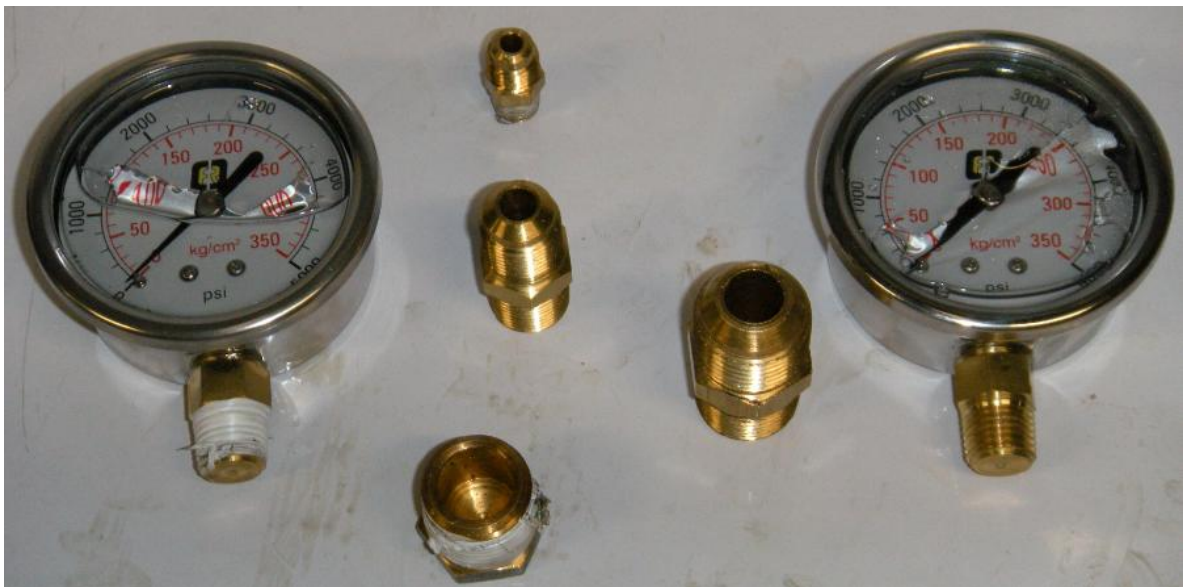
Figura 98. Manómetros, racores y tapones hidráulicos.
