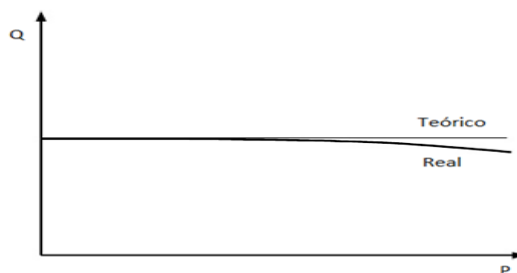
Figura5. Curva característica caudal-presión de una bomba de desplazamiento positivo.
