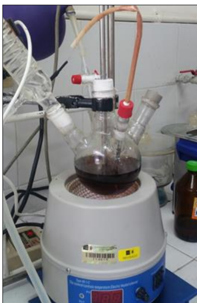
Figura 8. Montaje empleado para la transesterificación de aceite de ricino.
