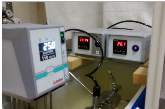
Figura 15. Montaje para control de temperatura en baño de agua empleado para la célula de equilibrio por decaimiento de presión.
