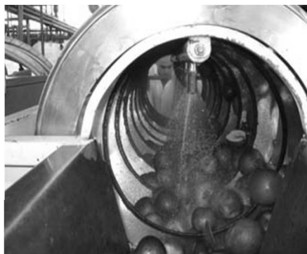
Figura 11. Lavado por aspersión en tambor giratorio
