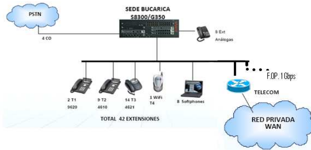
Figura 3.15 Red de ToIP en la sede de Bucarica (Cortesía ASSEDA con algunas modificaciones).
