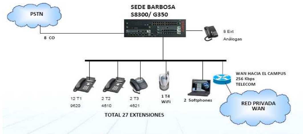
Figura 3.17 Red de ToIP en la sede de Barbosa (Cortesía ASSENDA S.A. con algunas modificaciones).
