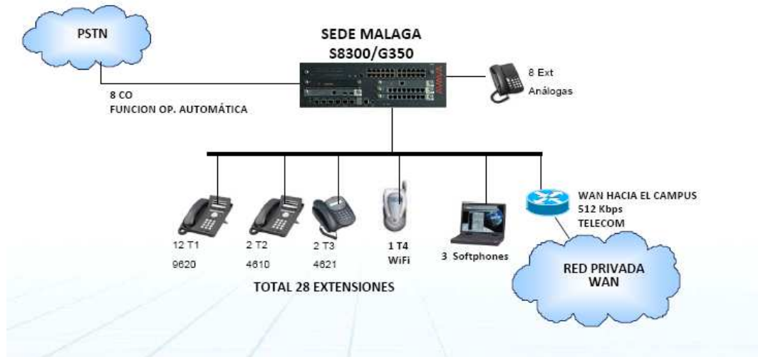
Figura 3.18 Red de ToIP en la sede de Malaga (Cortesía ASSENDA S.A con algunas modificaciones).
