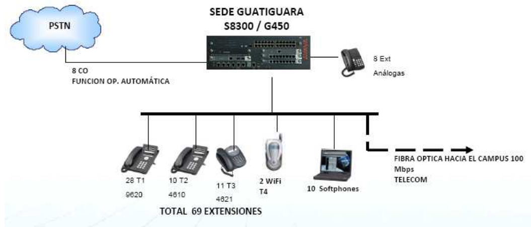
Figura 3.14 Red de VoIP en la sede de Guatiguará (cortesía ASSENDA S.A.).
