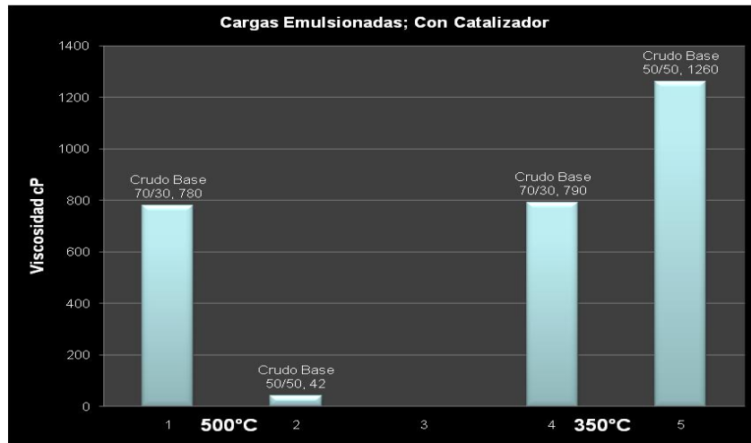
Figura 34. Efectos de la temperatura y la proporción de crudo liviano a pesado.
