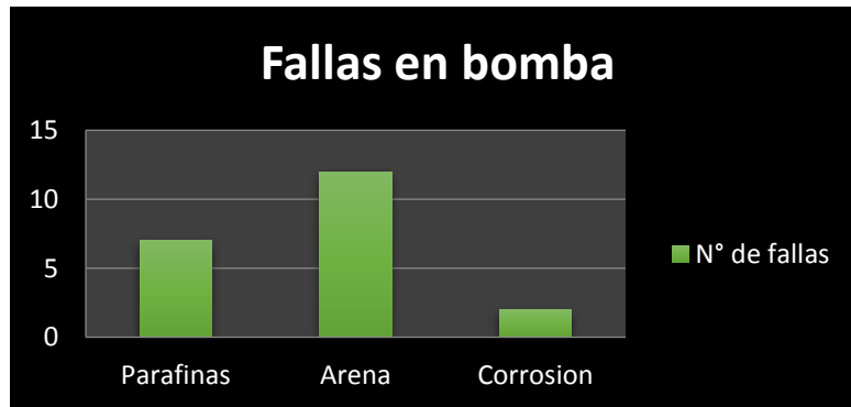
Figura 11. Distribución de fallas en bomba
