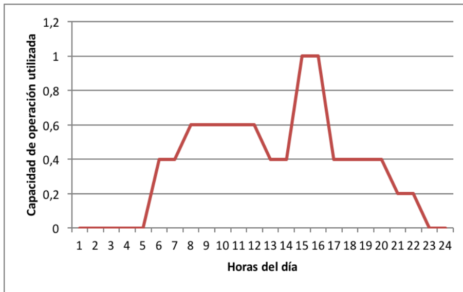
Figura 13. Comportamiento general del uso de la capacidad de equipos en el control integrado de consumo energético.
