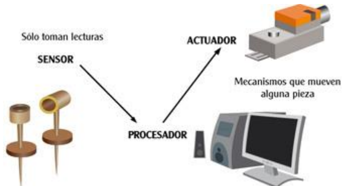
Figura C.4. Componentes del sistema de control por presencia.
