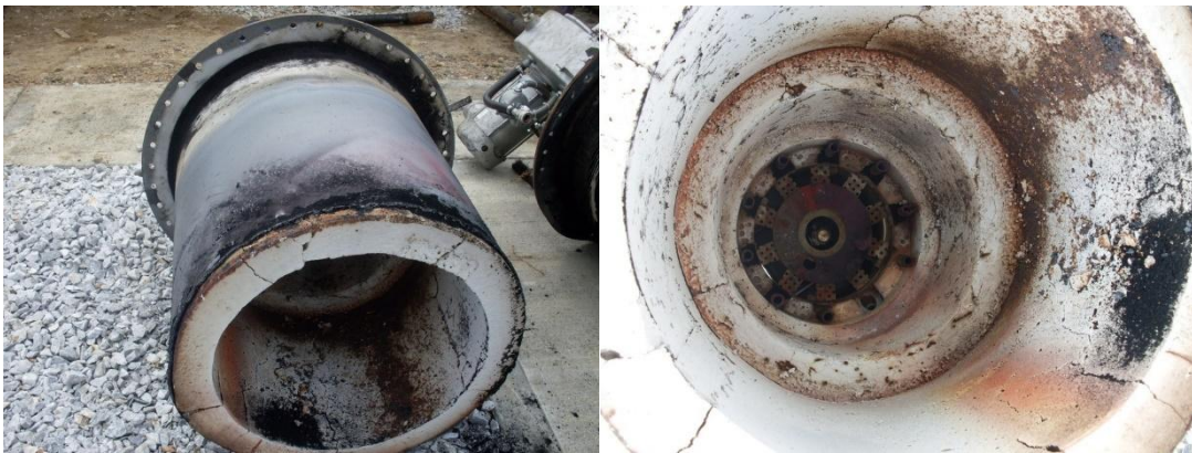
Figura 21. Quemador del Tratador Electrostático– Sección frontal
