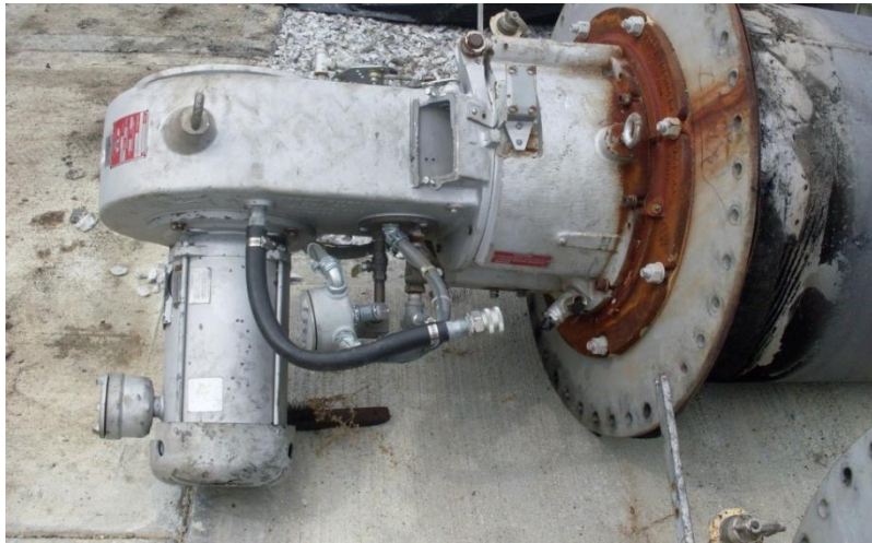
Figura 20. Quemador del Tratador Electrostático – Sección trasera
