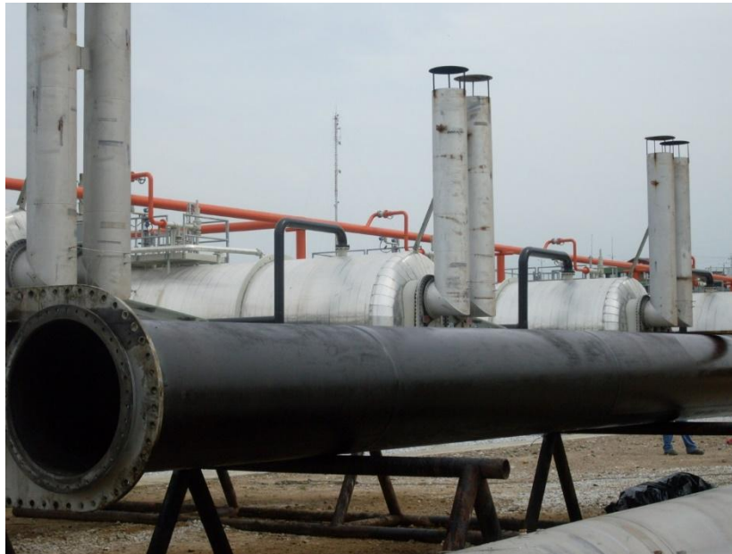
Figura 22. Tubos de fuego de un Tratador Electrostático
