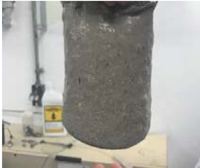
Figura 37. Prueba Polímero entrecruzable más 80 lpb carbolita, sistema B2.1, fractura 2mm.
