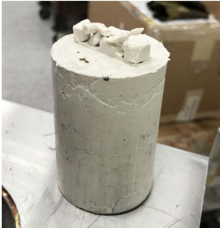
Figura 18. Revoque de la píldora al deshidratarse, sistema A1.
