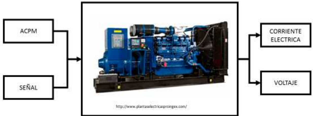
Figura 20 Sistema Planta Eléctrica
