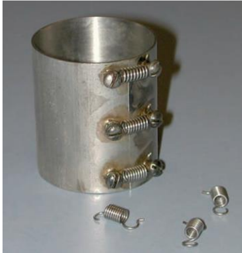
Figura 12. Manga cilíndrica para mediciones de expansión del cemento
