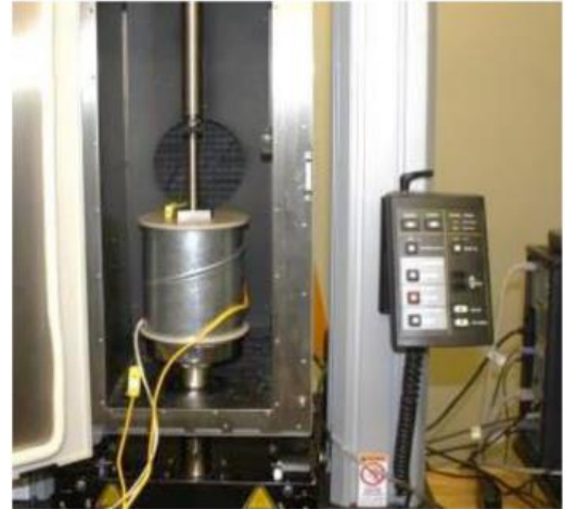
Figura 35. Izquierda, Celda de coeficiente de esquemático para la medición de expansión. Derecha, Maquina de pruebas mecánicas
