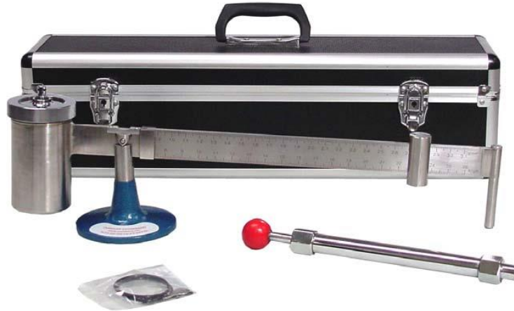
Figura 2. Balanza de Lodos y cementos presurizada para medir densidad de la mezcla
