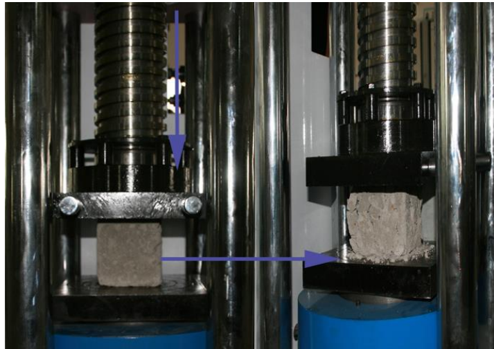
Figura 6. Prueba destructiva de Resistencia a la Compresión
