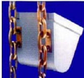
Figura 86. Elevadores de descarga positiva
