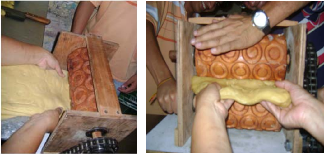
a. Etapa de suministro de la masa.
