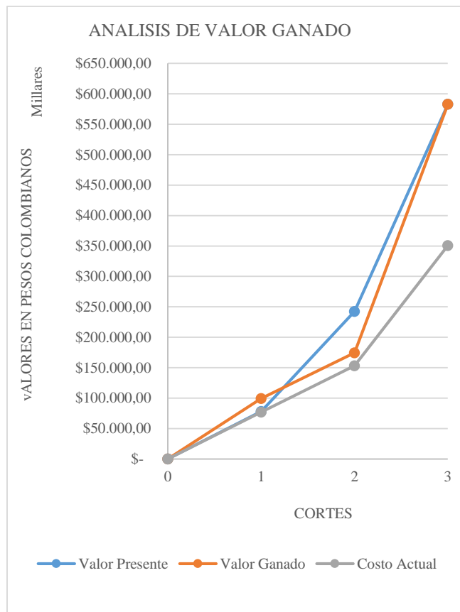
Figura 3. Análisis del valor ganado de tres cortes de obra del proyecto Pauna.
