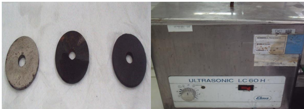
Figura 5.7. A la izquierda cupones después la prueba, derecha equipo utilizado para la limpieza ultrasónica.
