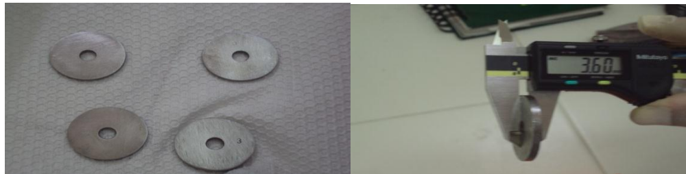
Figura 5.4. A la izquierda, cupones utilizados para el ensayo. A la derecha, medición de los cupones con el calibrador pie de rey.
