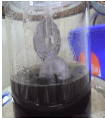
Figura 6.1. Cupones para la prueba: fase liquida, interface liquido-vapor y fase vapor.
