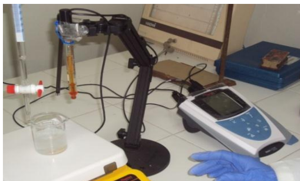
Figura 5.3. Montaje para la prueba reserva ácido/álcali
