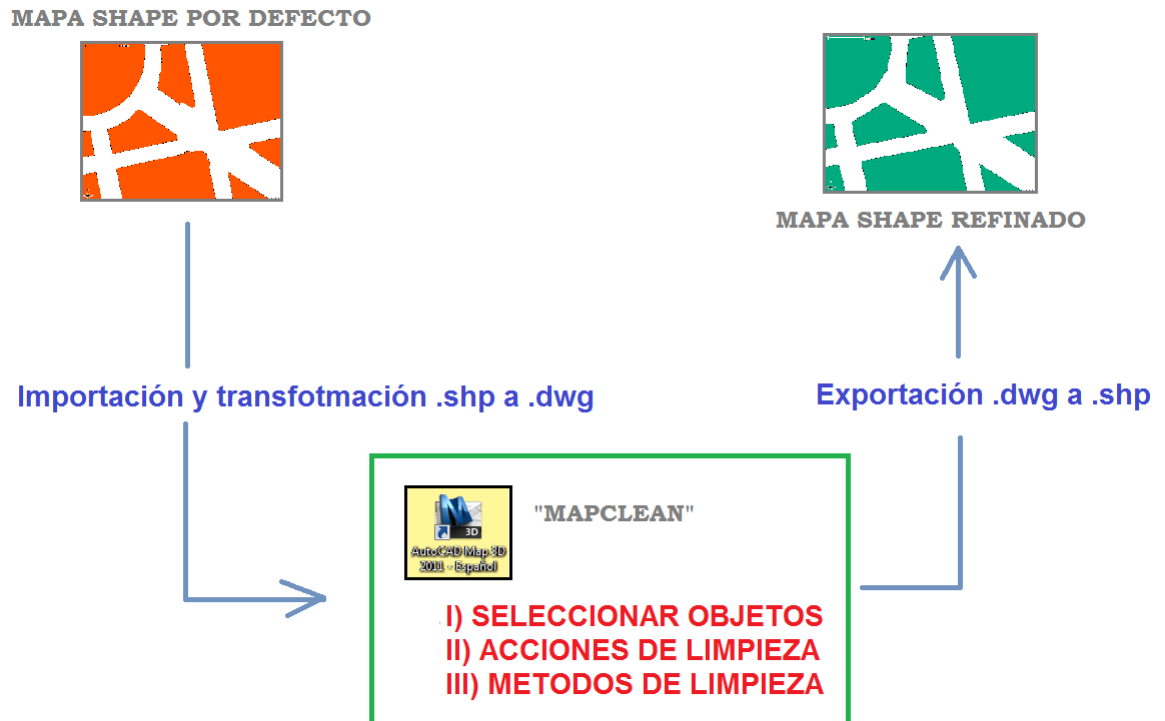
Figura 17. Proceso de Refinado geométrico para mapas Shape.
