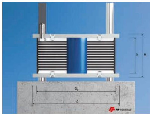
Figura 9. Esquema Aislador LRB. Fuente: Aisladores elastoméricos de caucho y plomo serie LRB. FIP INDUSTRIALE S.r.L.
