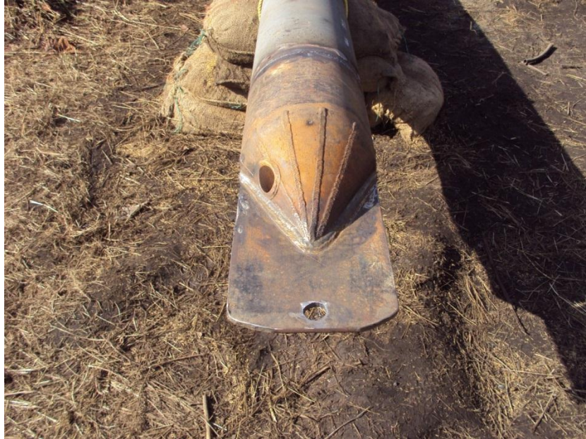
Figura 16. Punta de tubería para el halado
