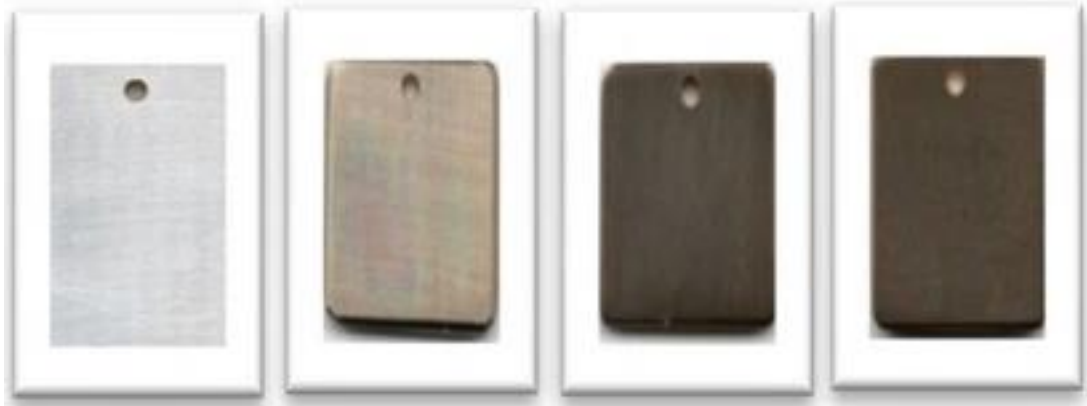
Figura 3. Macrografías de la aleación base sin recubrir y con recubrimiento a diferentes concentraciones de ácido (% en volumen).
