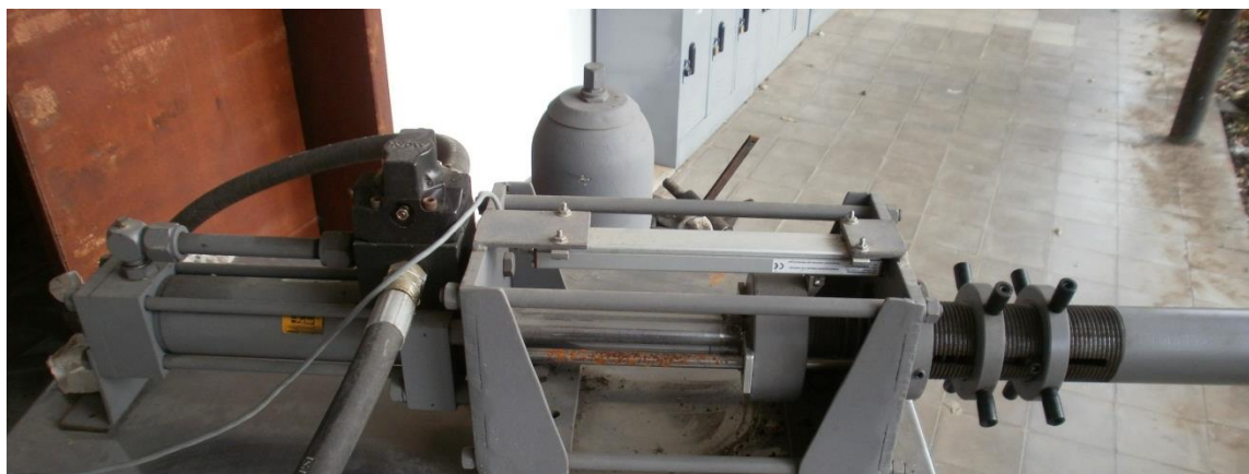
Figura 35. Banco de experimentación para servosistema hidráulico de control de posición (servoválvula Moog 760 y actuador)
