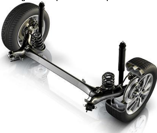
Figura 8. Suspensión No Independiente
