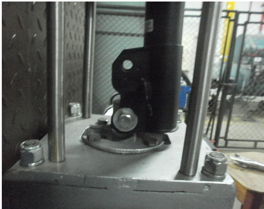
Figura 69. Ajuste Inferior del amortiguador
