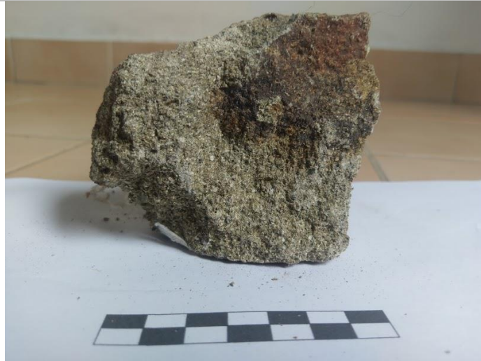
Arenisca gruesa ligeramente gravosa con presencia de cemento calcáreo. Presenta un color verde grisáceo y se encuentra granosoportada. Composicionalmente se clasifica como una sublitoraenita calcárea ligeramente gravosa. Sus granos son subangulares y tiene un calibrado moderado. Unidad: Formación Bocas
