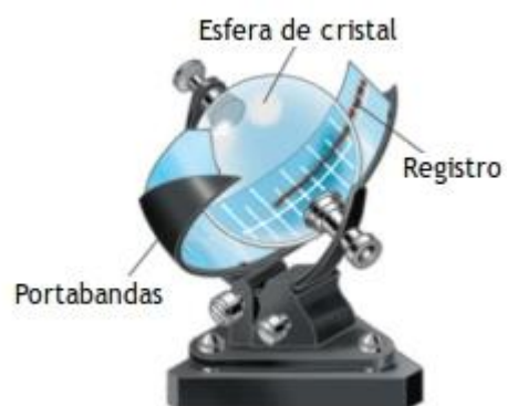
Figura 16. Fotografía y componentes de un heliógrafo de Campbell-Stokes.
