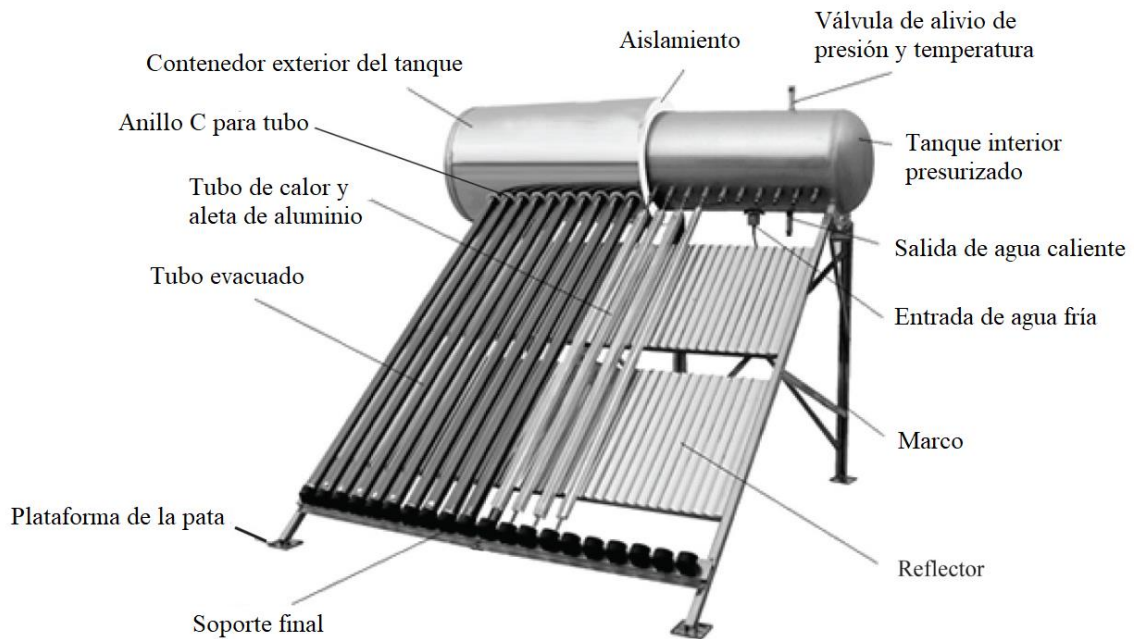
Figura 20. Partes de un colector solar de tubos al vacío.
