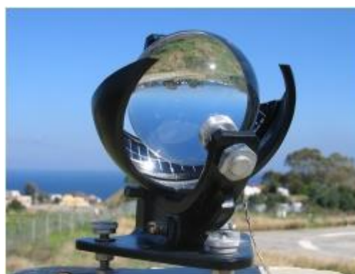
Figura 16. Fotografía y componentes de un heliógrafo de Campbell-Stokes.
