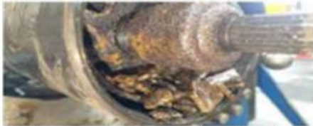
Fig 4. enormes trozos de sedimento en la cabeza y acumulación de sedimentos en el deflector.
