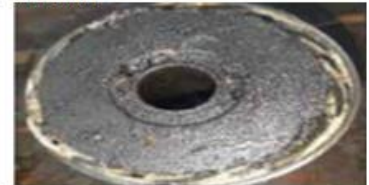
Fig 6. El paso del fluido del difusor está bloqueado por la acumulación de sedimentos.
