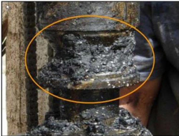
Deposición de Asfaltenos en una BES
