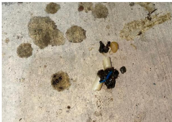
Ilustración 14. Obstáculos y suciedad generada en los isotanques y causantes de taponamiento de líneas capilares
