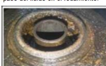
Fig 8. desgaste del faldón inferior de los impeilers
