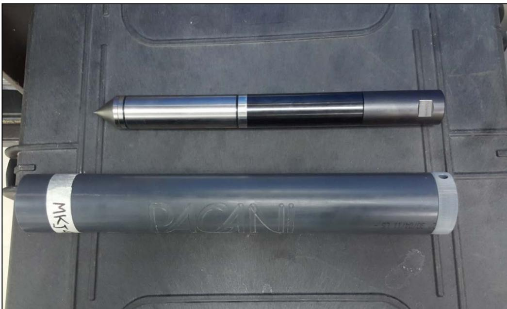
**Figura No. 18 Cono estático eléctrico. Fuente: GEOTECO S.A.S.**
