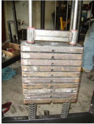
Figura 25. Montaje Planchuelas y Poleas
