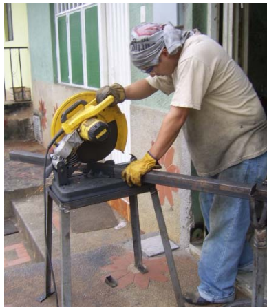
Figura 12. Máquina Cortadora de Metal de Disco Abrasivo
