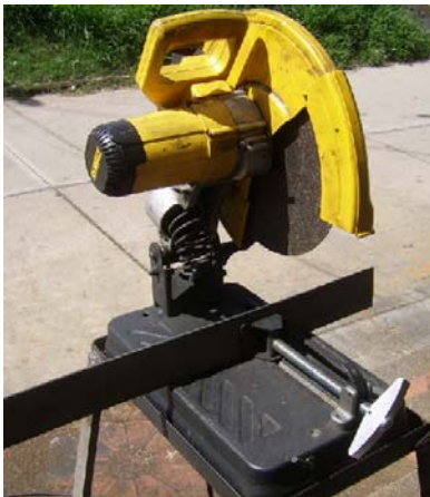
Figura 12. Máquina Cortadora de Metal de Disco Abrasivo
