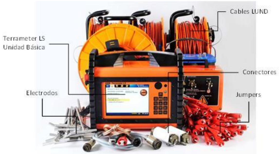
Figura 5. Terrameter ABEM LS, equipo utilizado para la medición de los datos de resistividad.
