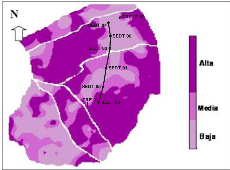
Figura 35. Mapa de distribución espacial de la densidad de fracturamiento en la Mesa de Los Santos.
