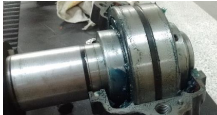
Figura 25. Bujes acoplados al eje conducido
