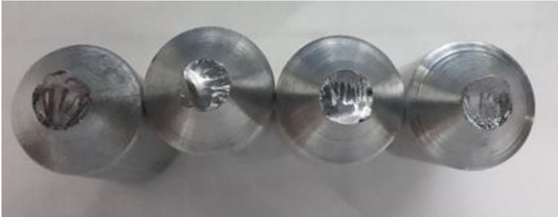
Figura 75. Sección de fractura de probetas sometidas a fatiga axial
