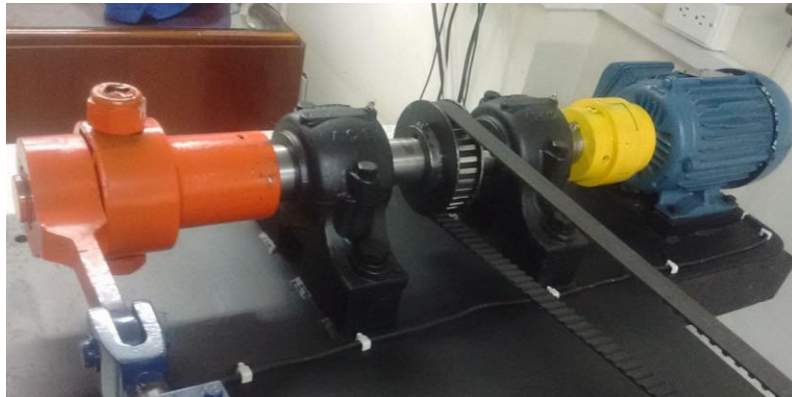
Figura 41. Montaje de rodamientos y poleas en el eje motriz
