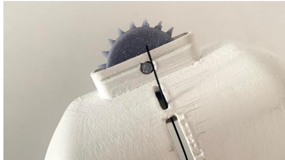
Figura 35. Rueda de Wartenberg en el prototipo funcional.
