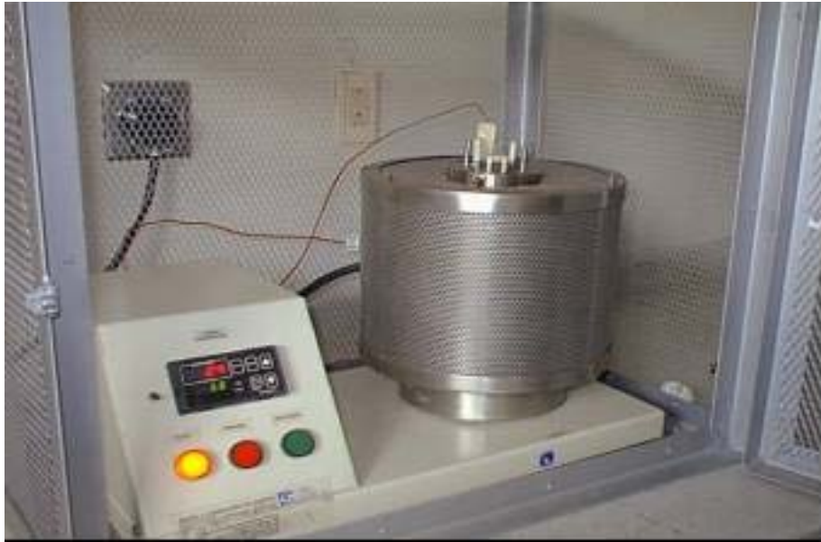
Figura 13. Horno para el desarrollo de ensayos electroquímicos.
