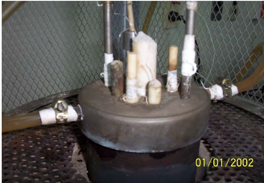
Figura 19. Montaje de la tapa del crisol en el horno.
