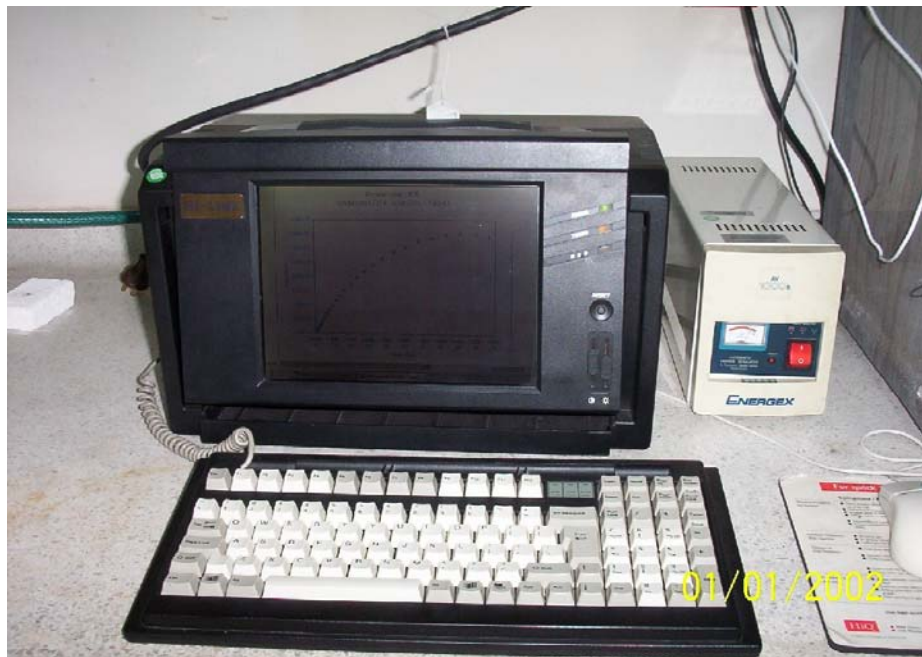
Figura 14. Potenciostato GAMRY para el desarrollo de ensayos electroquímicos.
