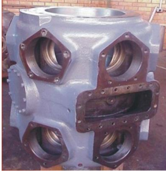
Figura 5. Cilindros compresores de gas marca Superior.
