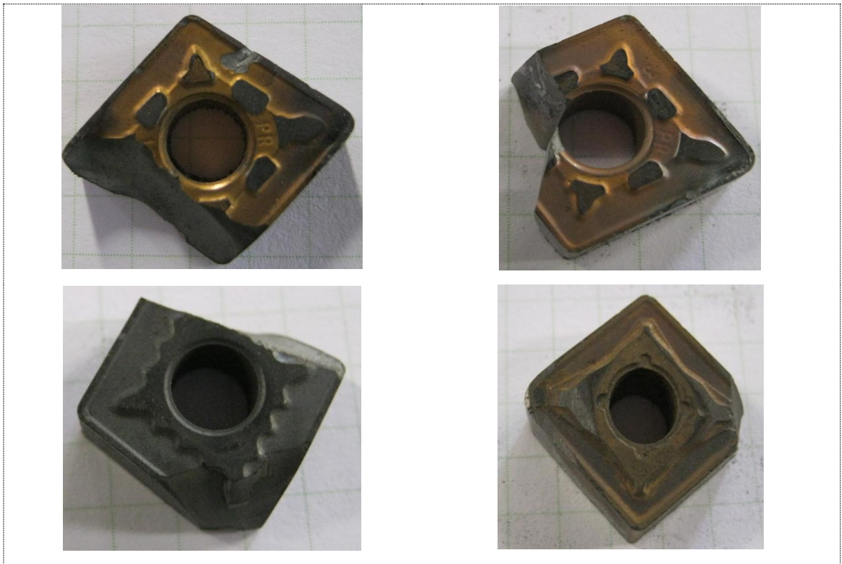
Figura 41. Daños en los insertos
