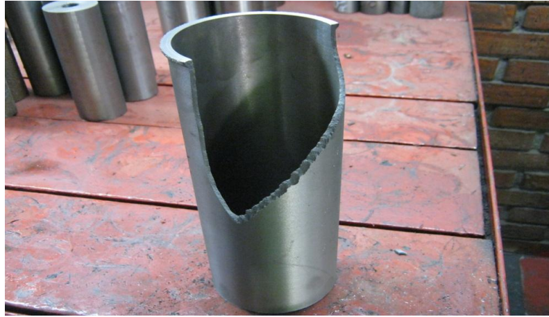
Figura 42. Material de desecho posiblemente debido a problemas de fundición
