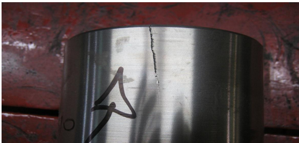
Figura 43. Evidencia de posible fallo a causa de porosidad en el material
