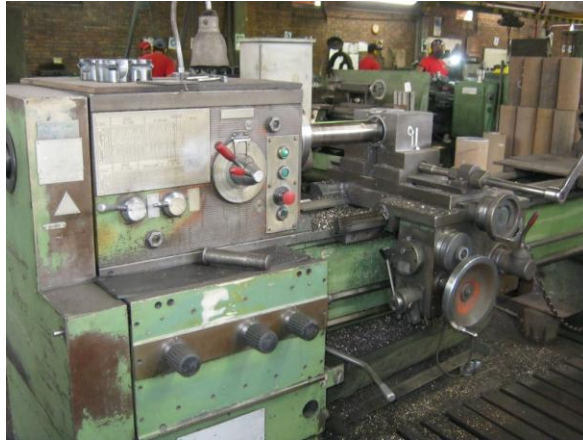
Figura 18. Equipo Utilizado para el desbaste interior.
