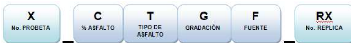
Figura 2.3. Nomenclatura de las probetas
