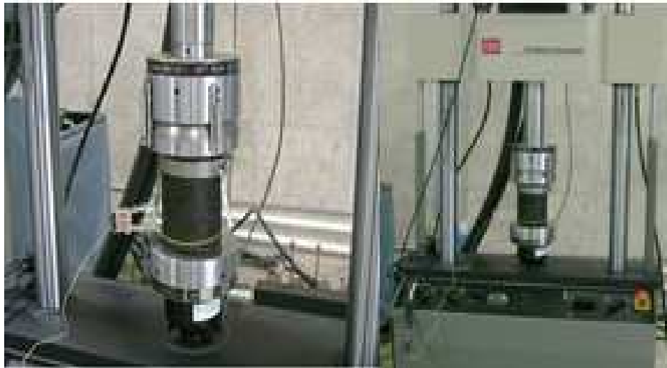
Fotografía 2.11. Ensayo módulo dinámico en la MTS-810
