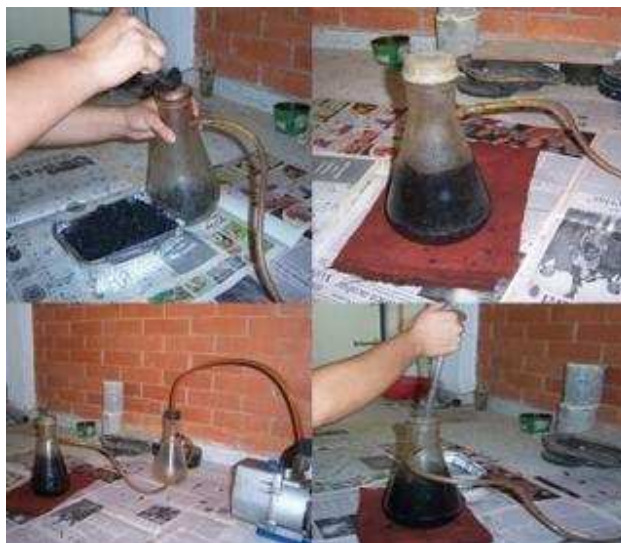
Fotografía 2. 8. Ensayo gravedad máxima teórica (Gmm)
