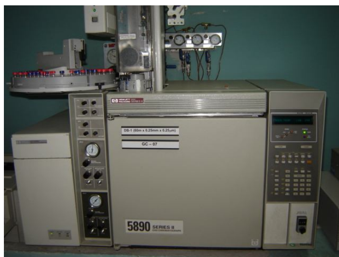
Figura 8. Cromatógrafo de gases acoplado al detector selectivo de masas (GC HP 5890 A – MSD HP 5972), empleado en el presente trabajo.
