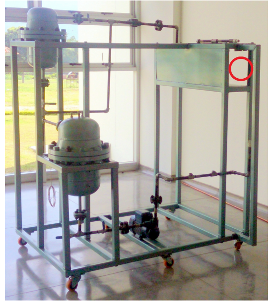
(b) Banco de pruebas en construcción. El círculo rojo señala el lugar dispuesto para la instalación del generador electrostático.
