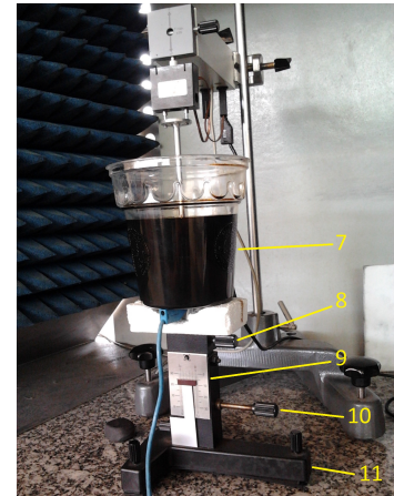
(c) Montaje de placas inmersas en crudo. 7: Contenedor con crudo (placas réplica inmersas) 8. Perilla de sujeción de placa inferior. 9: Escala graduada de altura de placa réplica inferior. 10: Perilla de fijación de altura de placa réplica inferior. 11. Soporte de contenedor y placa inferior.
