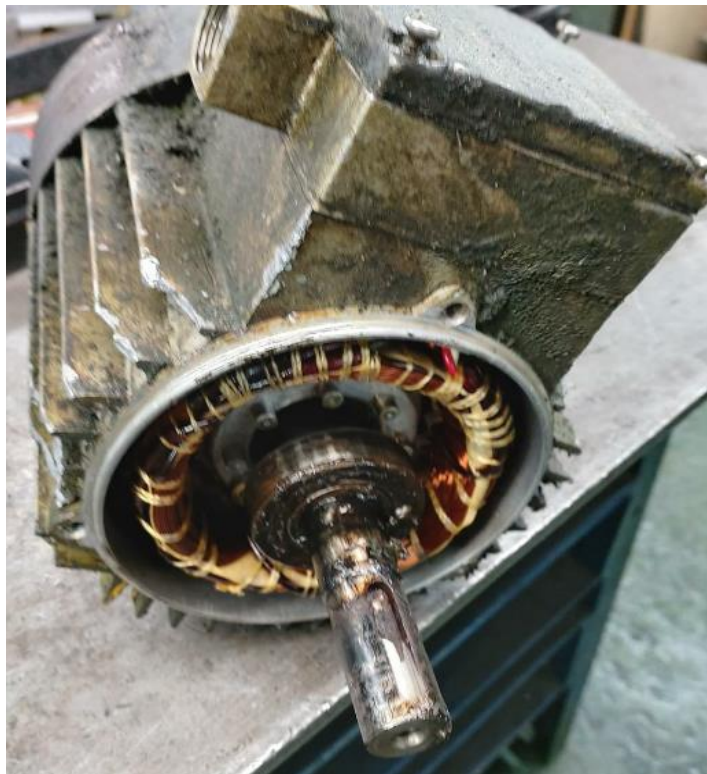
Figura 18. Daño de Rodamiento en Bomba de lubricación de la máquina KBA 215 # 3
