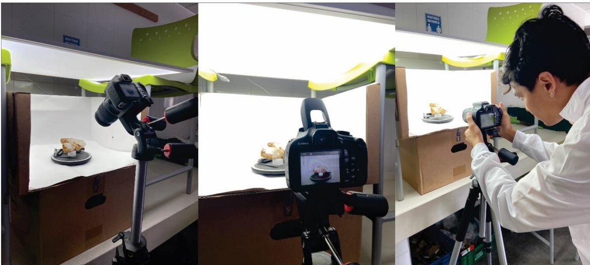
Ilustración 3. Proceso de ensamblaje y toma de fotografías en diferentes ángulos para generar el modelo tridimensional.
