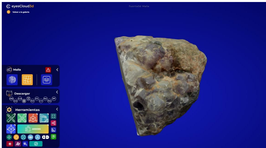
Ilustración 5. Plataforma eyesCloud3d donde se edita la malla una vez cargadas las 144 fotografías para finalmente generar el modelo tridimensional como se observa en el ejemplo de la Fluorita.
